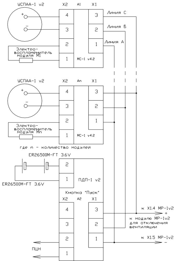
Типовая схема подключения УСПАА-1 при организации централизованного пуска от резервированного источника питания РИП.
