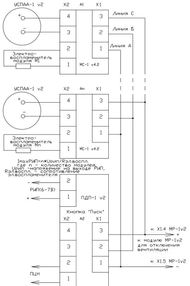
В качестве автономного источника следует использовать батареи с малыми токами утечек и выходным током не менее чем сумма всех пусковых токов электровоспламенителей. Например, для запуска 10-15 электровоспламенителей с пусковым током 0,1 А рекомендуется использовать автономный источник из двух литиевых батарей фирмы EEMB Co.Ltd типа ER26500M-FT (арт. 16-18-97). Параметры: максимальный ток до 2 А, срок сохранения 10 лет, температура минус 45...+85 °С.
