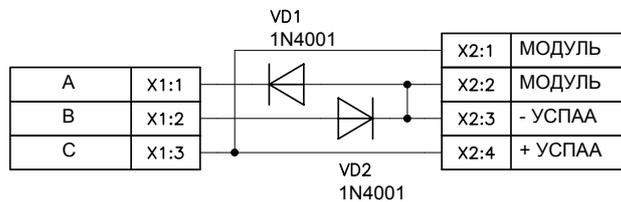
**Модуль дистанционного пуска ПДП-1 v2 «УСПАА-1 v2»**
