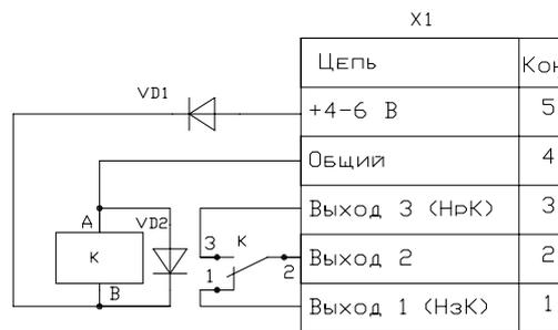
**Модуль сопряжения МС-1 v4.2 «УСПАА-1 v2»**
