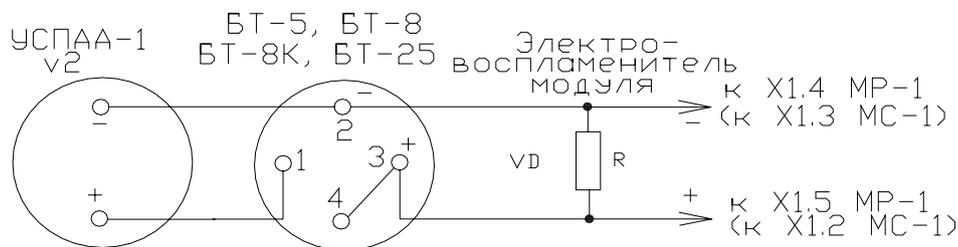
Схемы организации группового пуска модулей пожаротушения
